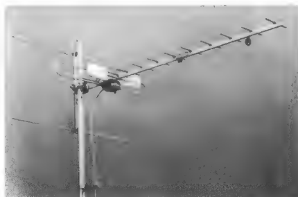
Bild 4. Kombinationsantenne mit 16 Elementen für vier Kanäle des Fernsehbereichs III und 25 Kanäle des Fernsehbereichs IV/V zum Empfang von Sendern aus annähernd gleichen Richtungen
