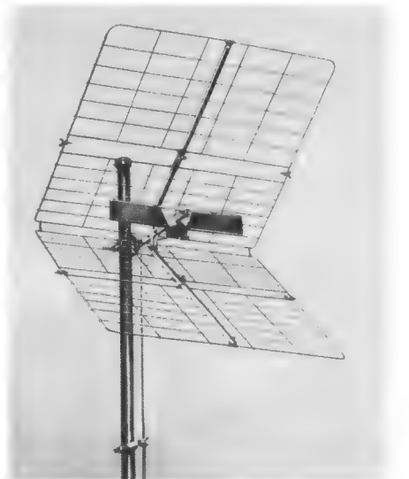
Bild 5. Mehrbereich-Corner-Antenne für alle Kanäle der Fernsehbereiche IV/V
