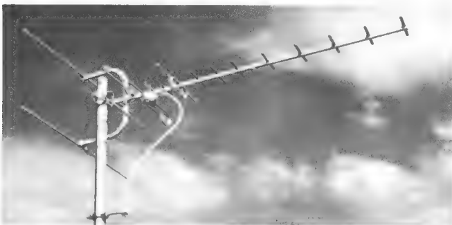
Bild 3. Fuba-Empfangsantenne Typ FSA 1 U 16 mit nur einem Dipol für die Fernsehbereiche III und IV/V
