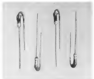
Bild 4. Kohleschichtwiderstände mit 1/8 W Belastbarkeit für die B1-Technik (natürliche Größe)
