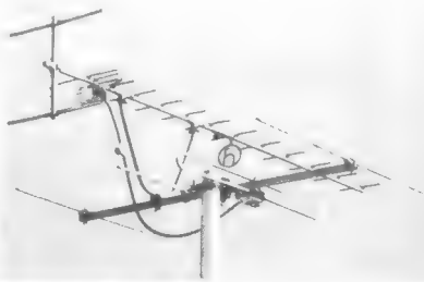
Bild 2. Mehrbereichs-Antenne Fesa 4/16 M von Hirschmann; der UHF-Teil läßt sich mit seinem Tragbügel in jede beliebige Richtung drehen (vgl. auch Seite 225 dieses Heftes)
